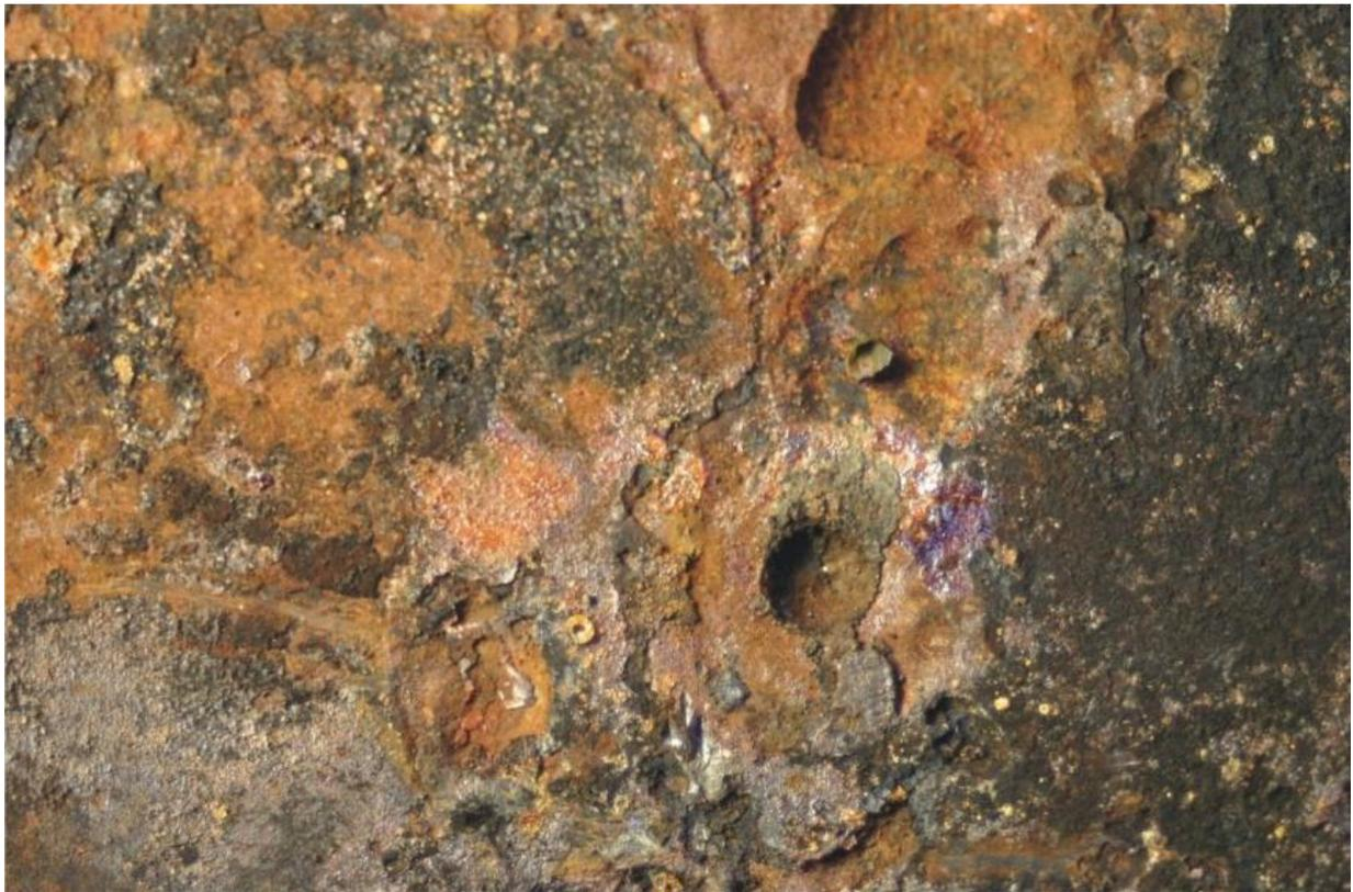
Рис. 4. Внешний вид язвы с продуктами коррозии на внутренней стенке трубы
